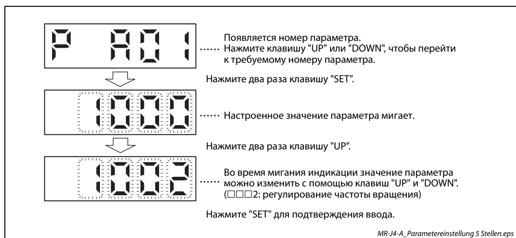
Рис. 6-10: Изменение PA01 с "регулирования положения" на "регулирование частоты вращения"
